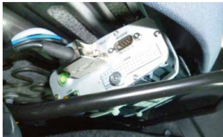
Abb. 1: busDAQ-2 CAN-Bus Interface, Einbauort unter dem Beifahrersitz
