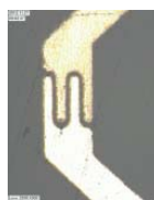
Abbildung 2: Einzelsensor mit durch die Messung unterschiedlich angegriffene Elektroden, Fingerbreite/-abstand: 5 µm.
