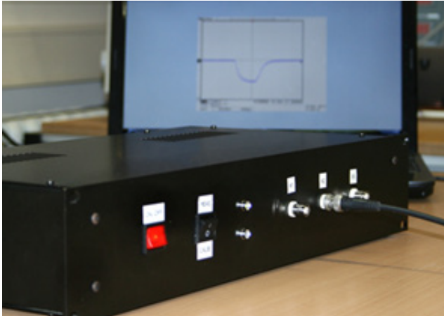
Abbildung 1. Schneller Zählwertschreiber zur Visualisierung der Netzfrequenz in einem 19` Zoll Gehäuse.
